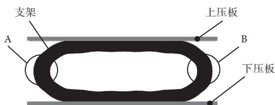
图 5 变形后的血管支架
