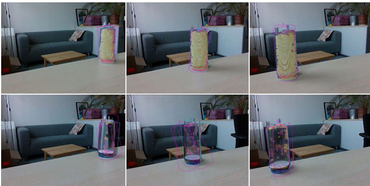
Abb. 4 Verifikation der Objektpose mittels inverser Projektion und Prüfungs der physikalischen Plausibilität der Pose im Vergleich zur Tischebene [8]
