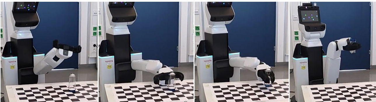
Abb. 12 Der HSR Service Roboter von Toyota greift erfolgreich ein transparentes Objekt
