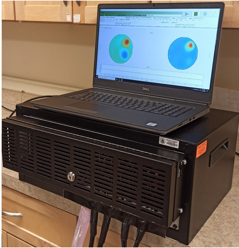
Fig. 1: Hardware of the ACT5 EIT system.
