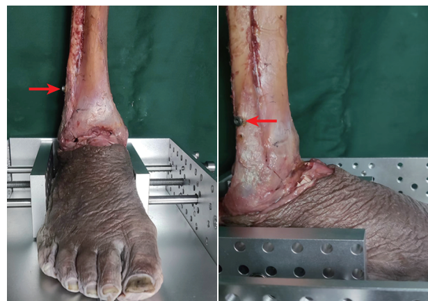
图2 标本固定于生物力学试验机示意图 箭头示皮质骨螺钉固定
