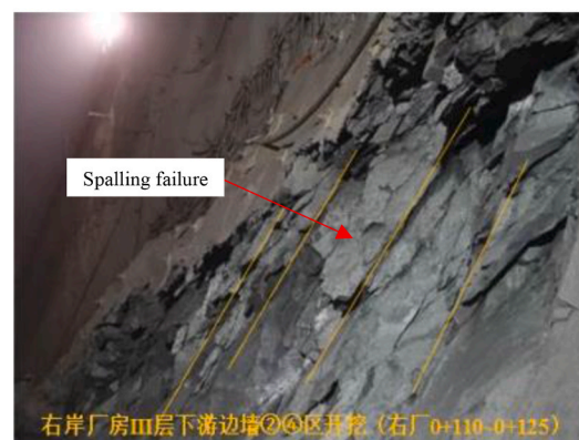
(d) Fracture morphologies at engineering site.
