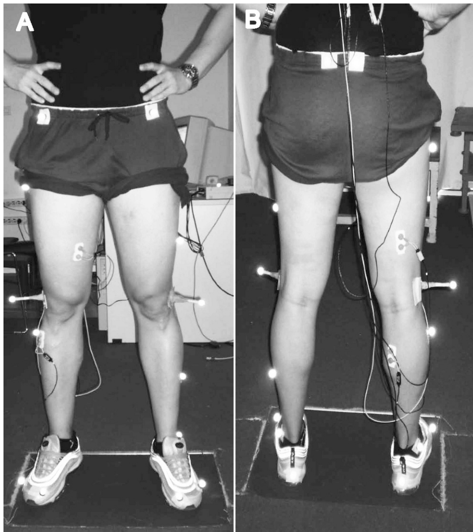
Figure. Marker and electrode placement. A, anterior view. B, posterior view.
