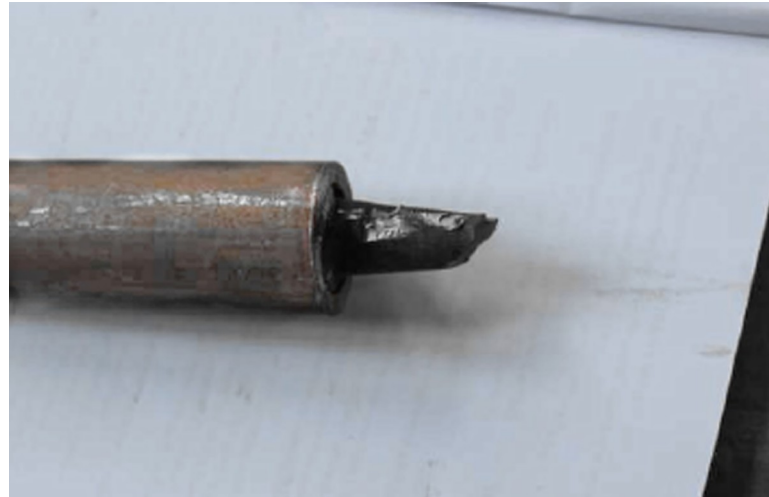
Fig 7. Failure mode of test bolt.
