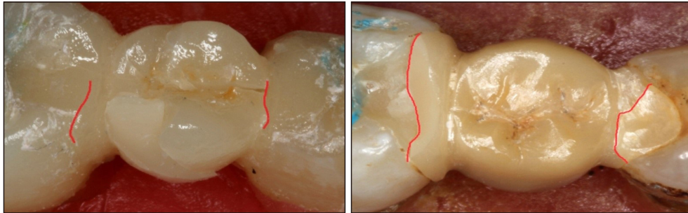
左:铸瓷组;右:氧化锆组。红线示修复体折裂的裂纹。
