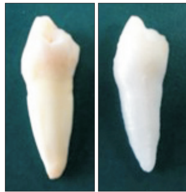
图1 体外牙(左)及FDM技术打印的个性化种植修复体(右)
