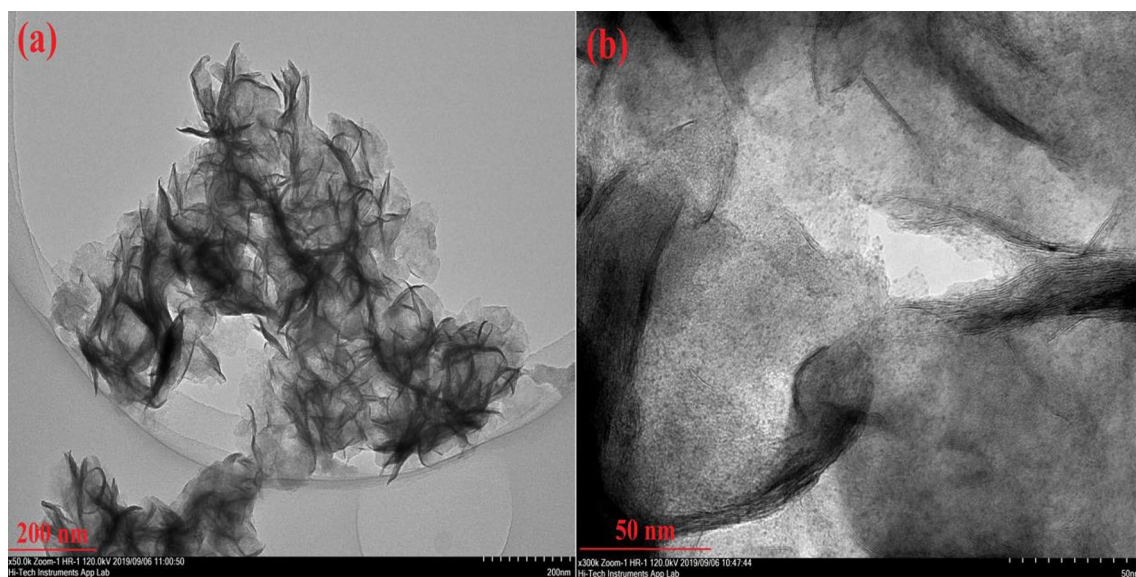
Fig. 4 a, b TEM image of Pt/Mo-90 composite
