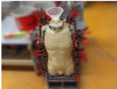
⑪ Close the torso mold and pour material
