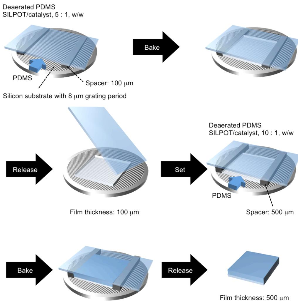
**Figure S6. Preparation of bilayer PDMS film.**
