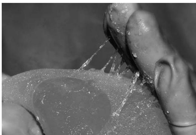
**Abb. 2** Defektes Implantat mit Gel-„Bleeding“ und sichtbarem Riss.
