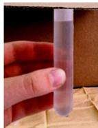
*Figure 1: Remplissez le tube en laissant un peu de place pour la sonde et le bouchon.*
