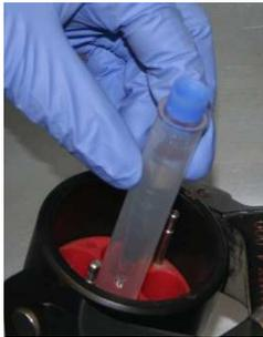
Figure 1 : Le tube collecteur est inséré dans un tube de centrifugation pour protéger la pointe pendant la centrifugation
