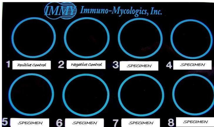
3. Déposez 25 µl du contrôle positif, du contrôle négatif et de chaque échantillon de LCR (traité par chauffage) dans les cercles correspondants. Utilisez un nouvel embout de pipette pour chaque réactif et pour chaque échantillon.
