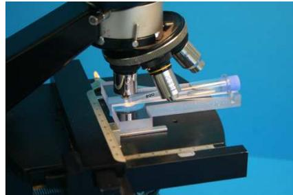
Figure 2 : Montage de la chambre de lecture et tube collecteur sous le microscope
