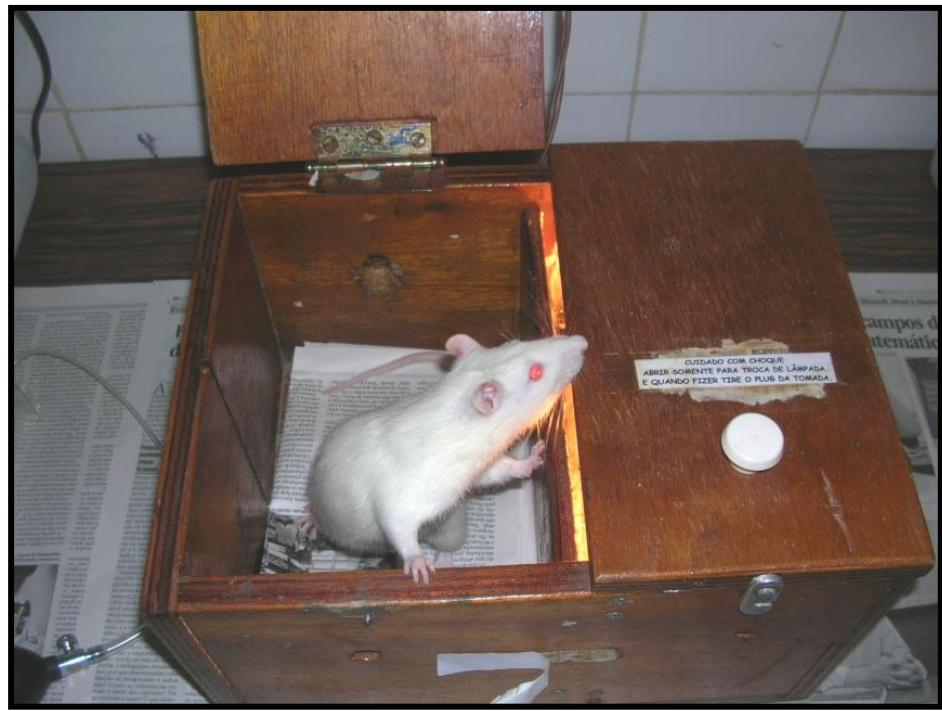
**Figura 9** - Caixa de aquecimento para aferição da pressão arterial
