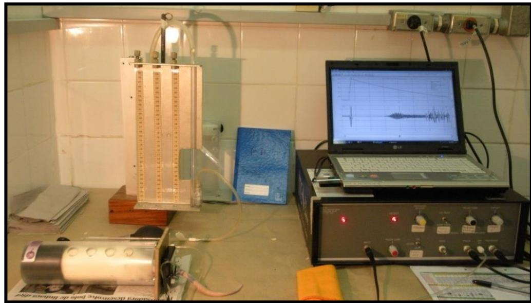
**Figura 10** - Aparelho de plethysmografia, animal posicionado no contentor de acrílico para aferição da pressão arterial.
