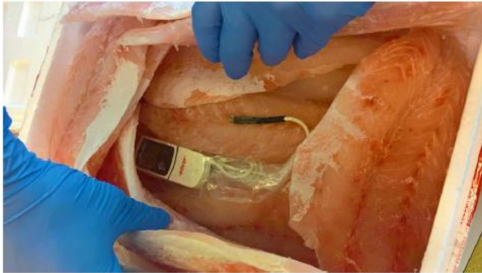
Foto 11. Zending uit Tanzania 08-06-2018 | Supreme Perch Ltd. Transport temperatuurlogger in de kern van de filets.
