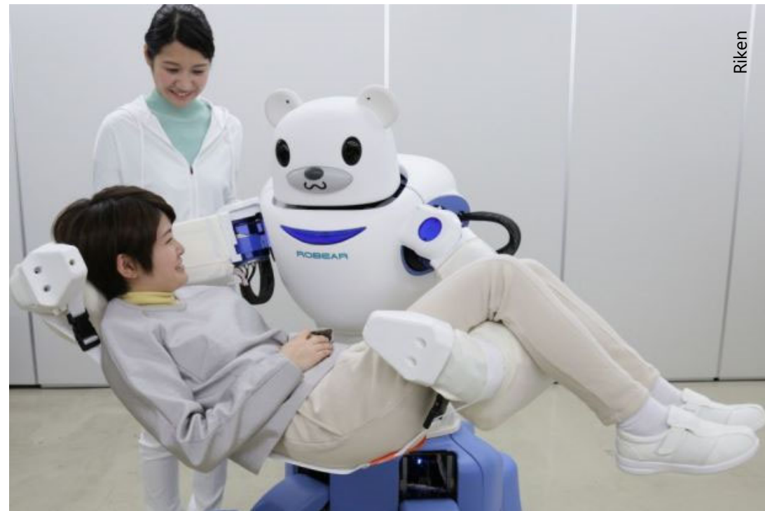
Der Serviceroboter „RoBear“ von Riken war stark genug, um einen Patienten zu tragen – er hatte aber keinerlei Fähigkeiten zur Emotionserkennung.
