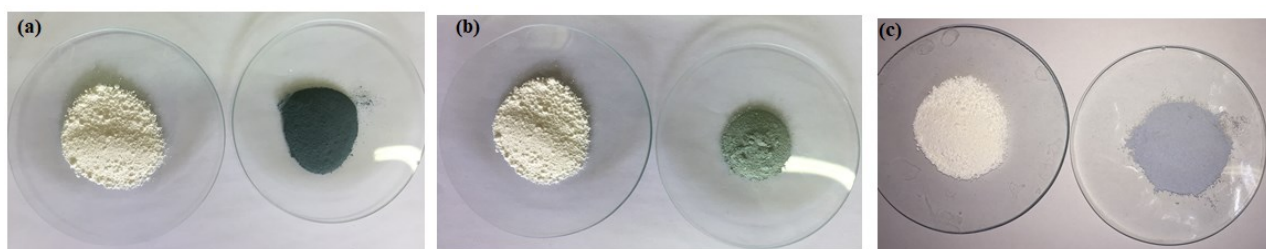
Fig.S6 The TiO 2 @5PAn (a), TiO 2 @2PEDOT (b), and TiO 2 @2PPy(c) compared to bare TiO 2 .
